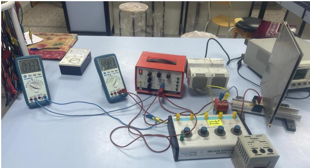
شكل 3 مكونات الدائرة المستعملة في اختبار حساب ثابت العزل الكهربائي
