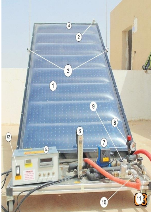
شكل (3) تركيب المجمع الشمسي المسطح نوع (RE550). [5].
