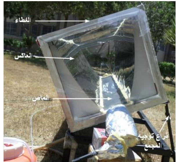
شكل 4. كامل منظومة المجمع الشمسي التركيزي.
