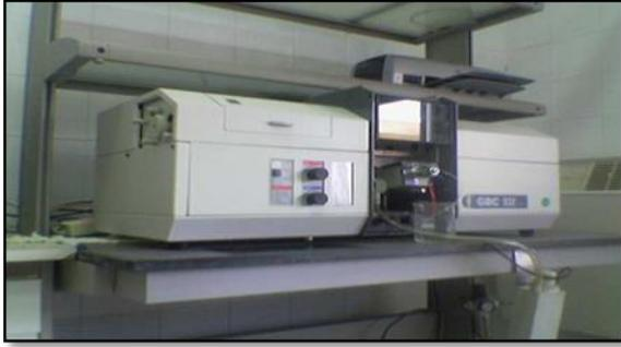
شكل 4 جهاز قياس الطيف الذري
