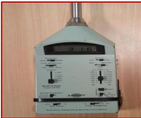
شكل 1. جهاز قياس الضوضاء
