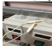
شكل (7) المستشعران الحراريان المستخدمان في الجهاز.
