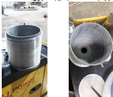
شكل (12) الحلة الصغيرة وعمل فتحة بقطر 4cm لتصريف المياه، وإحاطة الحلة الصغيرة بأنابيب النايلون.
