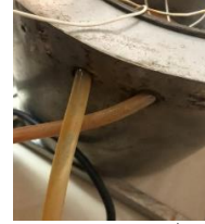
شكل (15) فتحتا دخول وخروج الماء من الأنبوب مرورا بالحلة الصغيرة من الخارج.
