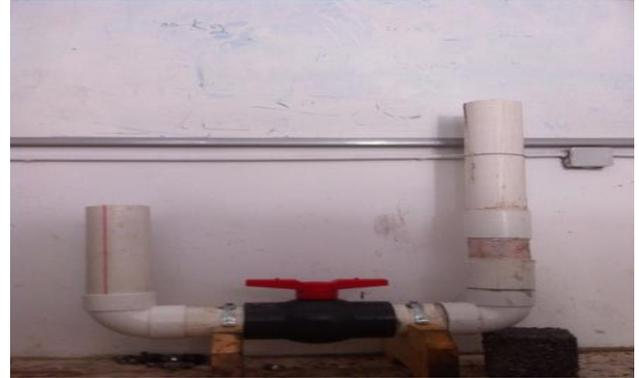
شكل (9) يوضح جهاز الضغط الثابت لقياس النفاذية
