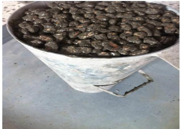
شكل (25) يوضح اختبار النضج للتدرج 10 – 12.5
