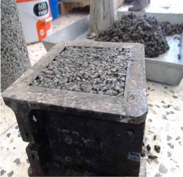
شكل (7) يوضح القوالب التي استخدمت لاختبار مقاومة الضغط
