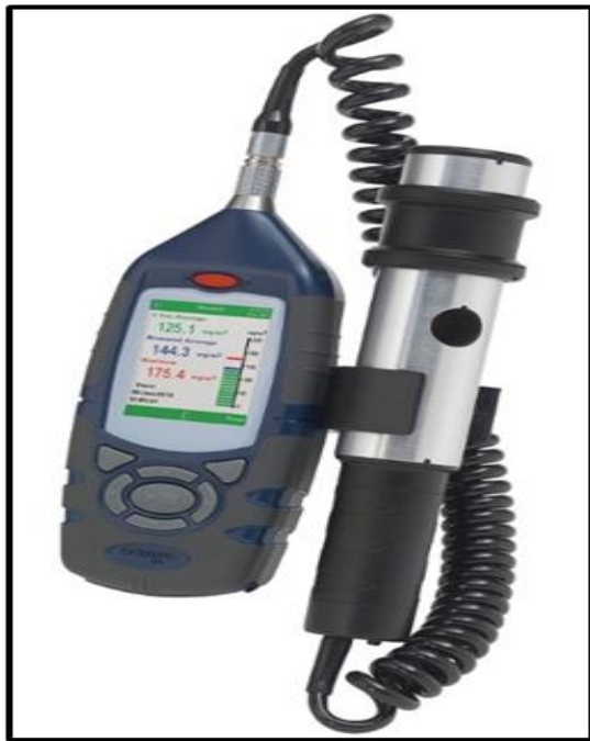
شكل 6. جهاز قياس الغبار Casella cel-712
