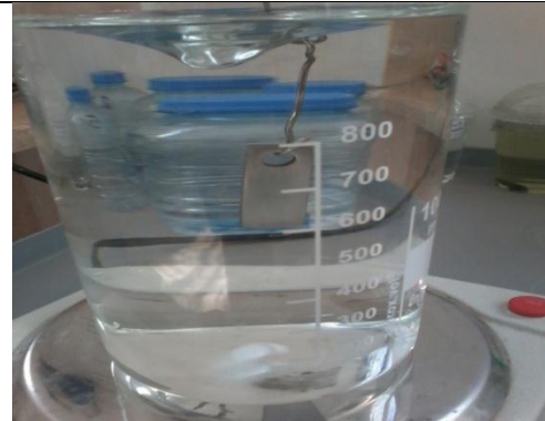
العينة اثناء الاختبار على المحرك المغناطيسي
