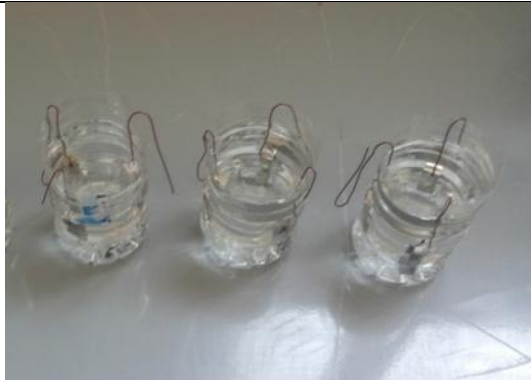
العينات اثناء الاختبار في الوضع الساكن
