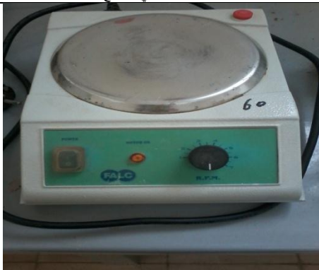
المحرك المغناطيسي المستخدم في تحريك السائل
