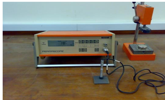
شكل 2. جهاز قياس السمك المستخدم
