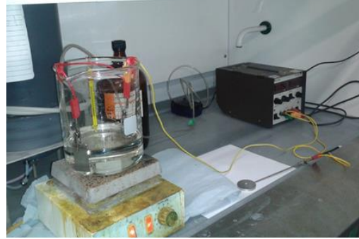
شكل 1. صورة توضح الخلية المستخدمة في عملية الانودة
