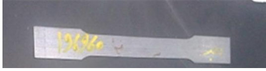
الشكل 4. عينة قياسية لاختبار الشد.
