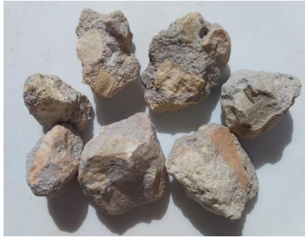
الشكل (2): حبيبات الركام المتحصل عليها من تكسير مخلفات الخرسانة (الركام المعاد تدويره).
