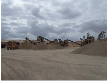
الشكل (1): آلات ميكانيكية (كسارات الحجاره).
