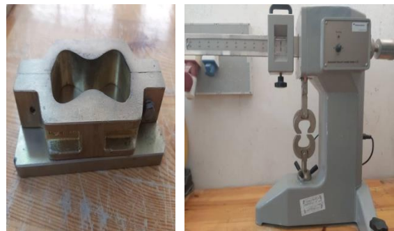
شكل 6. جهاز تعيين مقاومة الشد والقوالب المستخدمة في الفحص.
