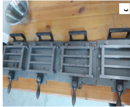
شكل 5. (أ) جهاز تعيين مقاومة الانحناء، (ب) القوالب المستخدمة في الفحص.
