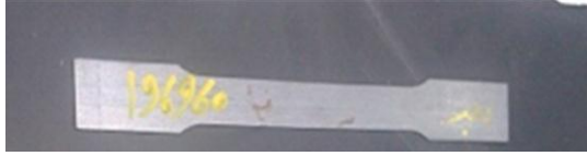
الشكل 4. عينة قياسية لاختبار الشد.
